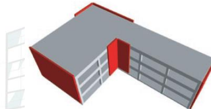
Postavljanje elemenata veće krutosti
